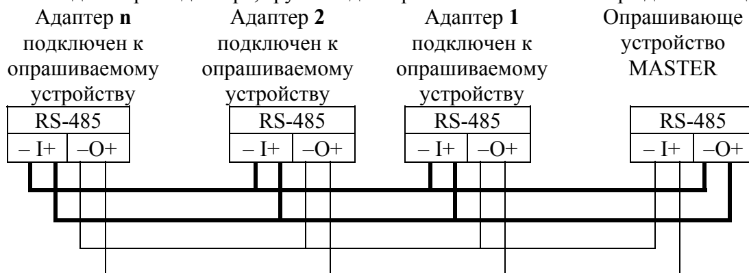
Рисунок 2 - Схема многоточечного соединения
